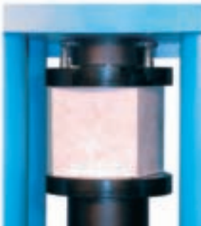
Сжатие бетонных образцов
