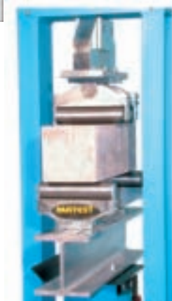
Изгиб образцов бетона
