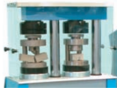
Сжатие/изгиб цементных образцов
